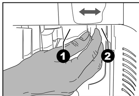
Метки указывают установленную степень помола; можно установить различные степени помола с помощью следующих меток:
