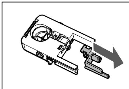
**13** Снимите соединение всасывающей трубки с Cappuccinatore.
