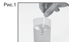
Измерьте жесткость воды с помощью тест-полоски, которая входит в комплект поставки, опустив ее на 1 секунду в воду.
